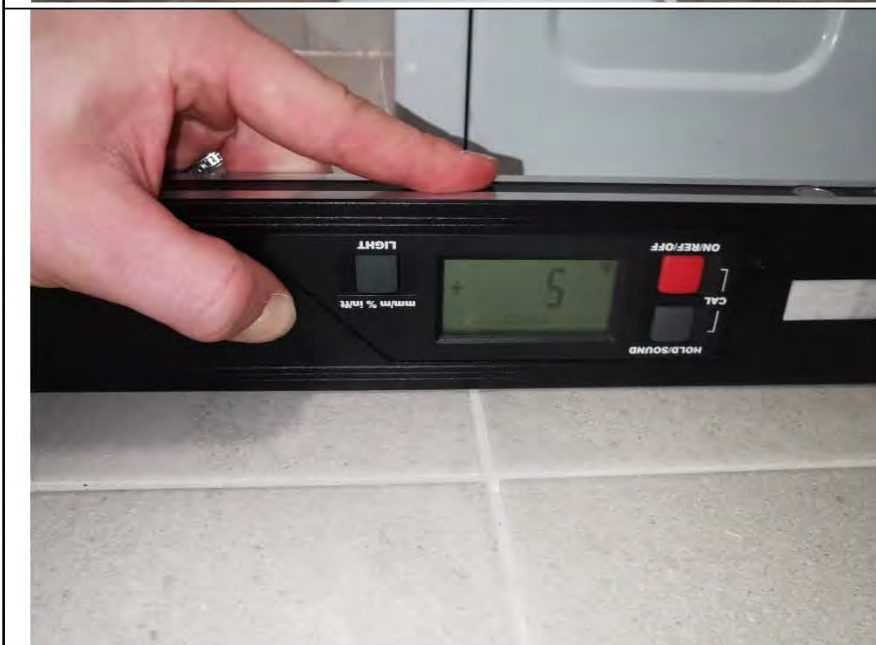
Фото №26. Измерение уровня пола в ванной комнате.
