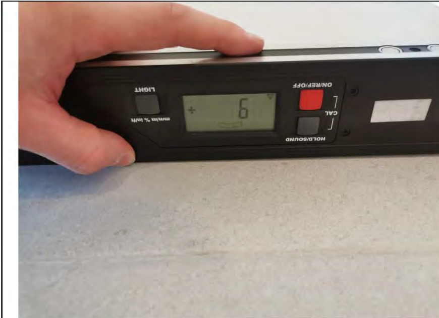
Фото №28. Измерение уровня пола в коридоре
