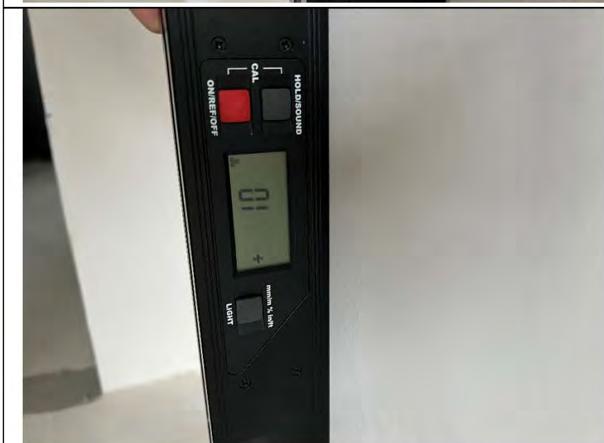
Фото №8. Измерение уровня стен в кухне.
