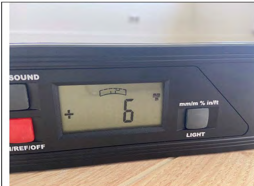
Фото №34. Отклонения напольного покрытия из ламината в детской.
