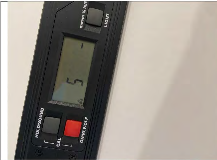
Фото №16. Измерение уровня стен в прачечной.
