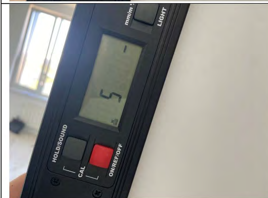
Фото №15. Измерение уровня стен в кухне.
