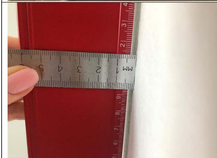
Фото №5. Измерение уровня стен спальни в квартире.
