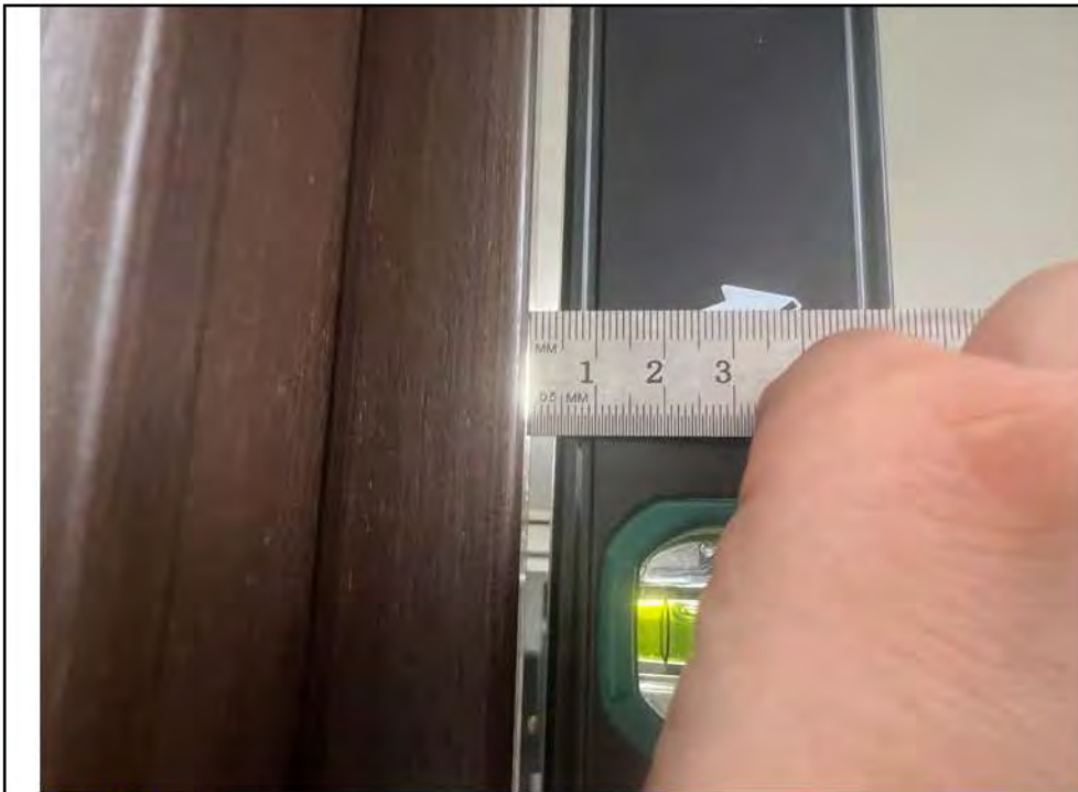
Фото №43. Отклонения прямолинейности дверного блока кабинета
