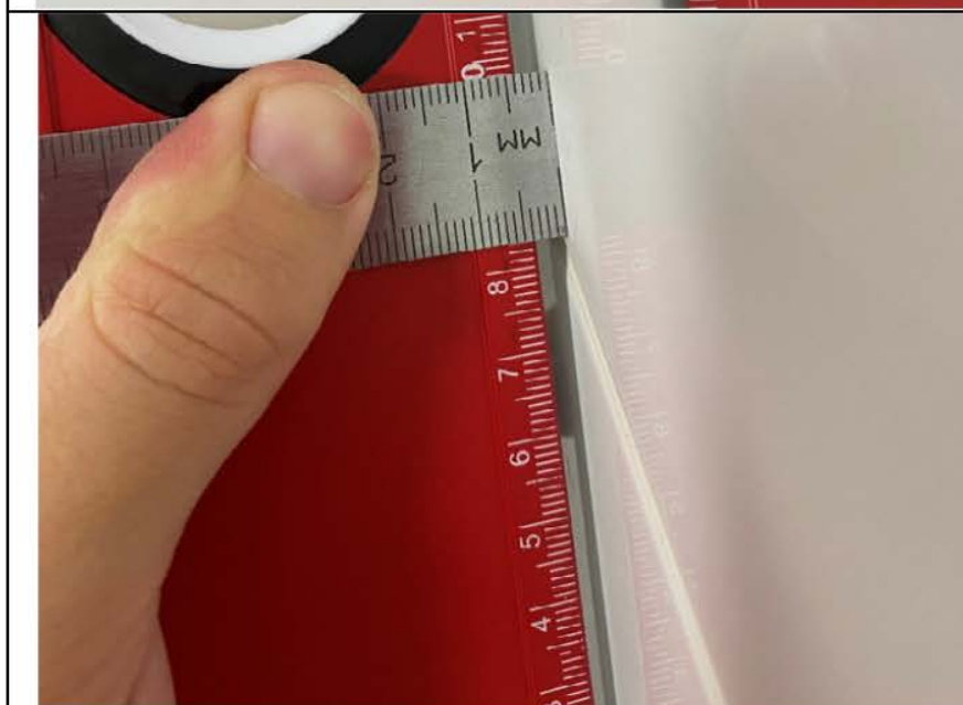
Фото №32. Измерение устройства настенного покрытия из керамической плитки в ванной комнате в квартире.
