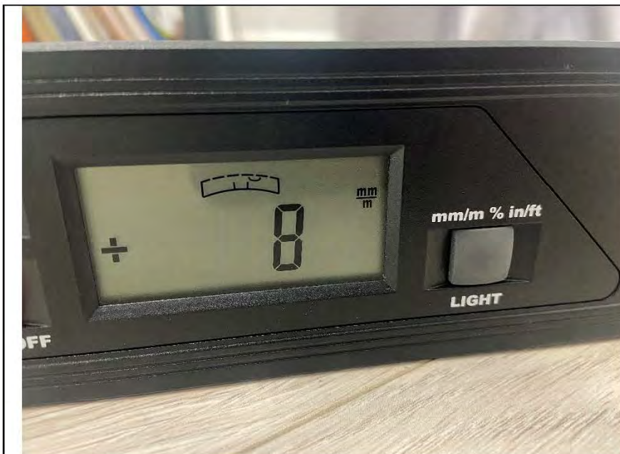
Фото №25. Отклонение поверхности напольного покрытия из ламината в гостиной.
