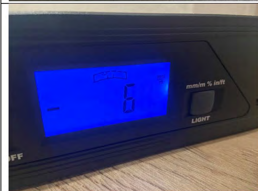
Фото №15. Отклонение поверхности напольного покрытия от плоскости в коридоре.
