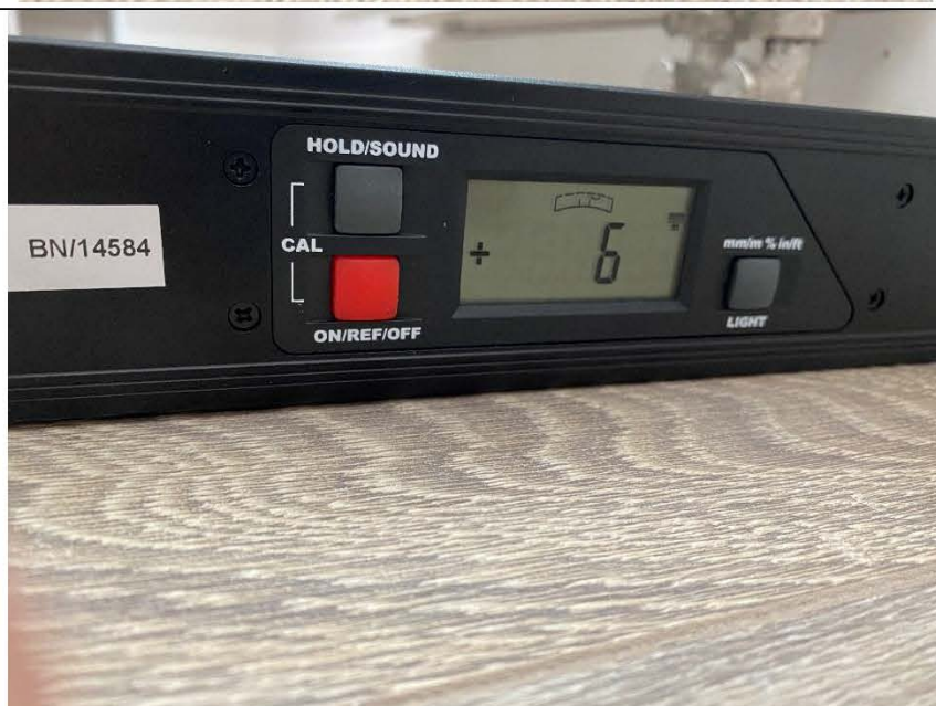
Фото №14. Измерение уровня напольного покрытия в кухне.
