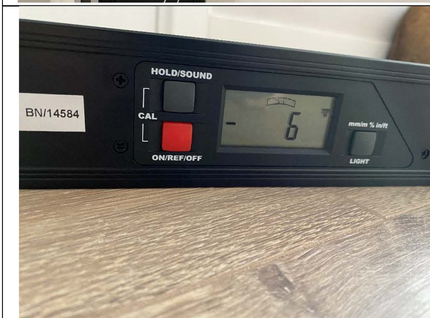
Фото №12. Измерение уровня напольного покрытия в коридоре.
