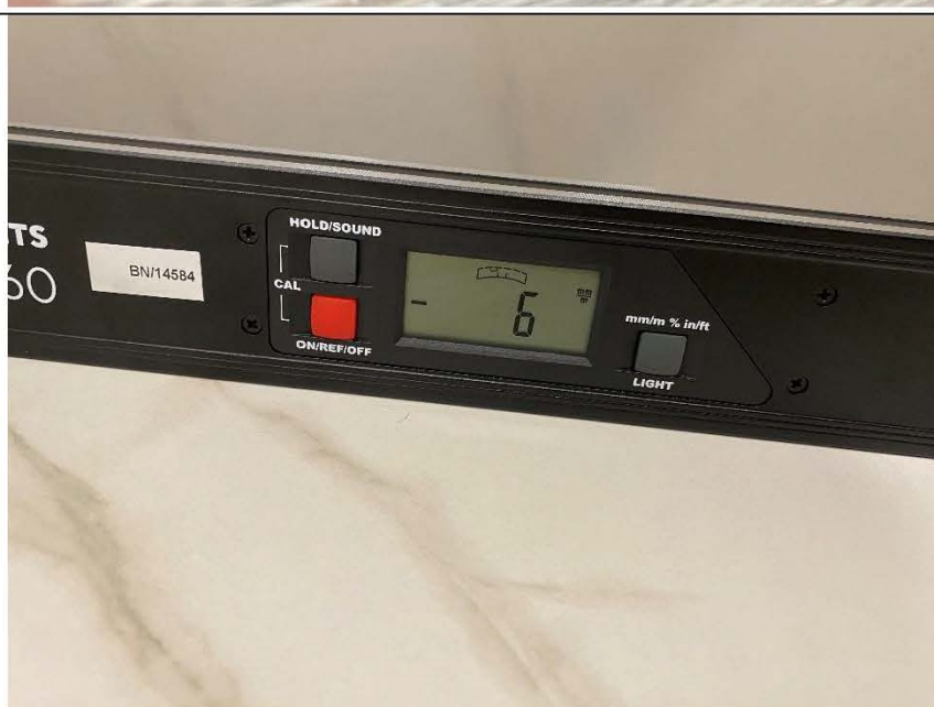
Фото №15. Измерение уровня напольного покрытия в ванной комнате.
