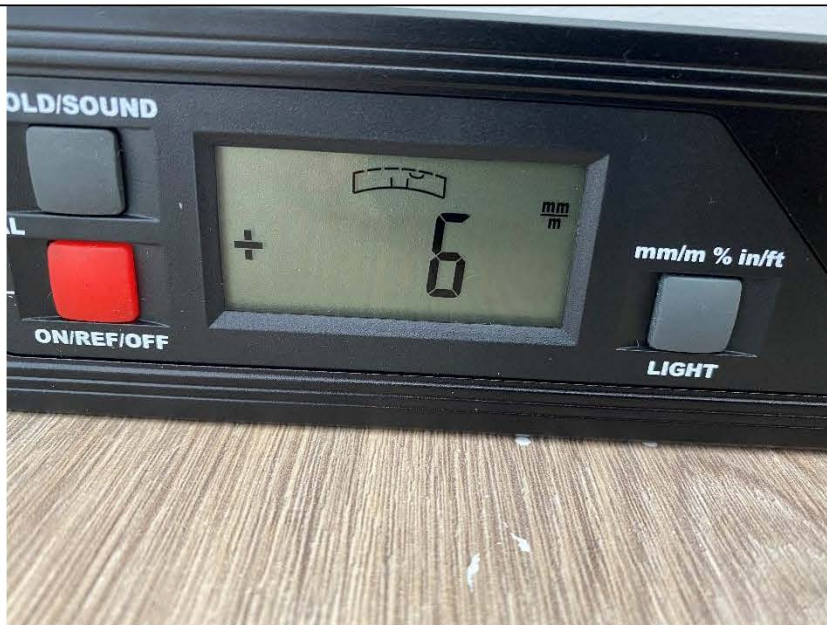
Фото №13. Измерение уровня напольного покрытия в спальне.
