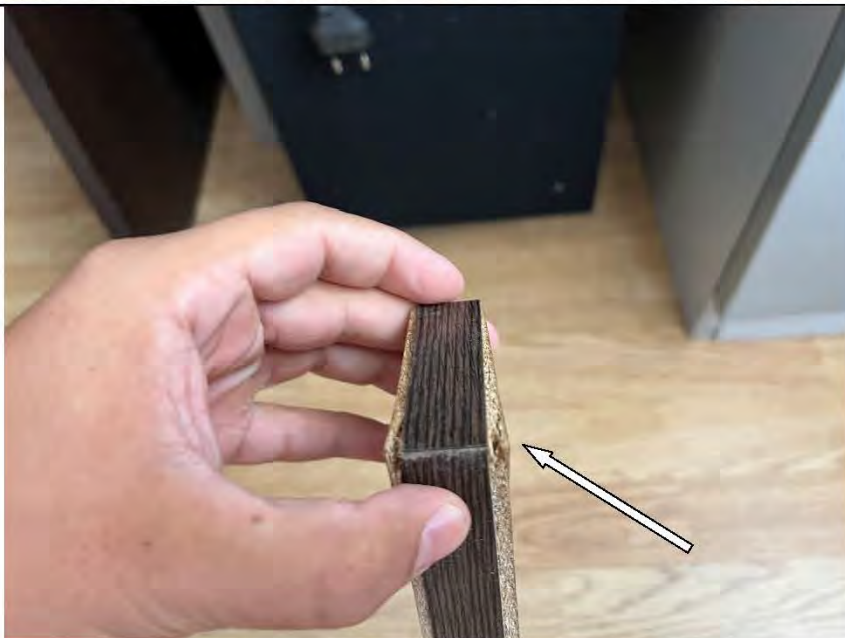
Фото №5. Расслоение нижней конструктивной части шкафа-стенки в гостиной.
