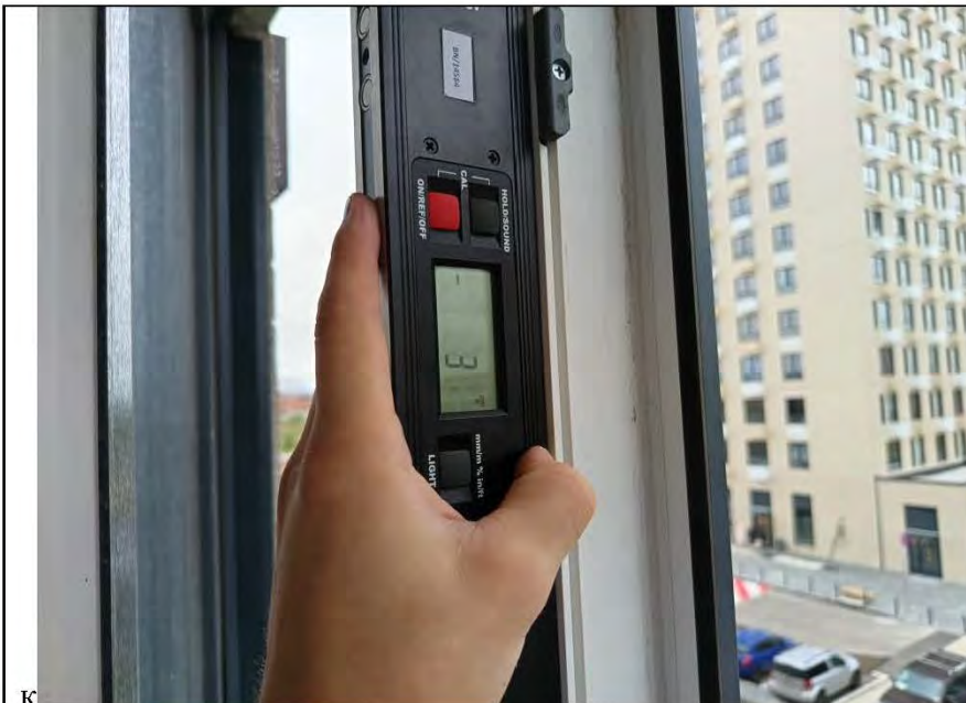
Фото №130. Отклонение оконного блока ПВХ в спальне.
