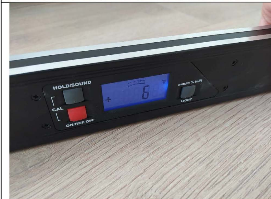
Фото №14. Измерения уровня напольного покрытия в гостиной.
