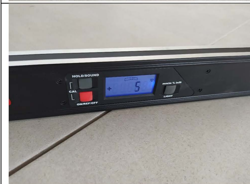
Фото №17. Измерения уровня напольного покрытия в кухне (керамическая плитка).
