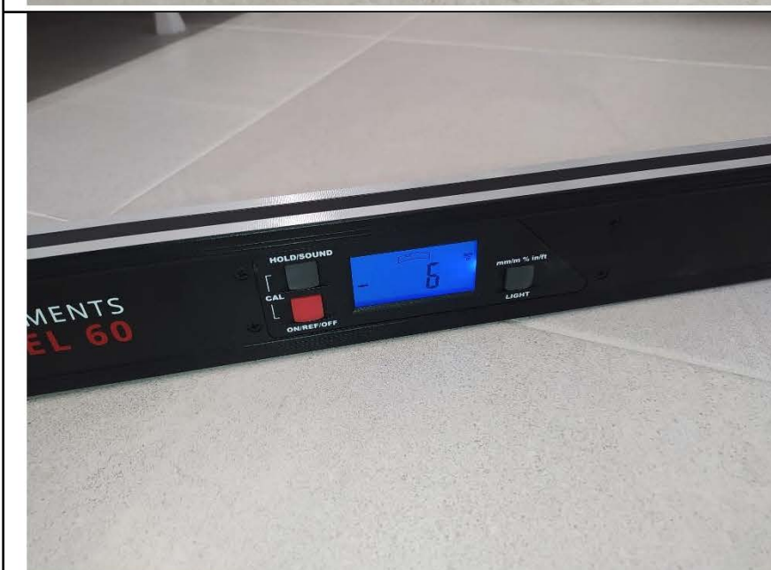
Фото №18. Измерения уровня напольного покрытия в ванной комнате (керамическая плитка).
