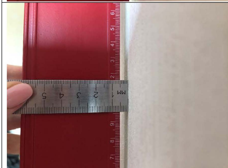
Фото №9. Измерение уровня стен спальни в квартире.
